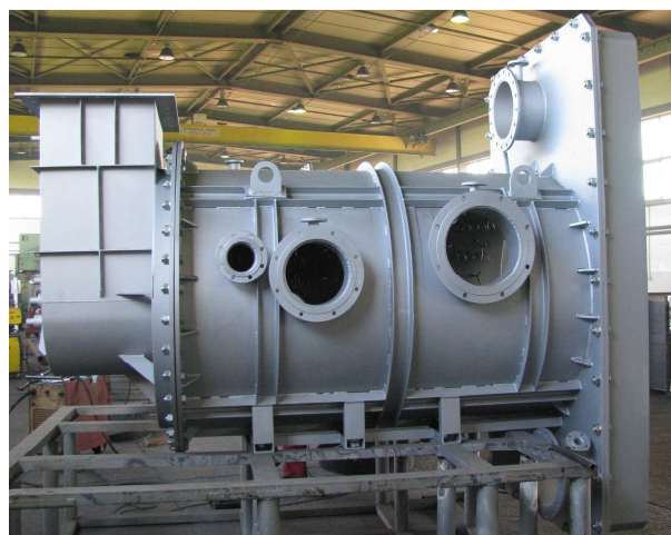
Palnik HTB-DL-WG15 – etap prefabrykacji
